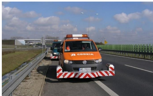
Fotografia 2. Wieloczułnikowy profilograf laserowy RSP-3
