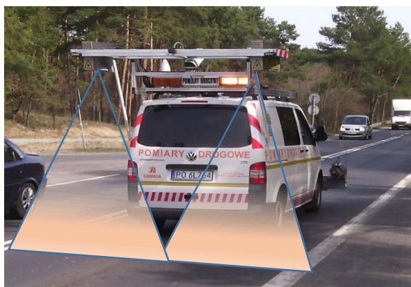
Rysunek 1. a) Zestaw do automatycznych pomiarów uszkodzeń nawierzchni; b) widok ogólnej zasady działania systemu do automatycznego rozpoznawania uszkodzeń powierzchni nawierzchni
